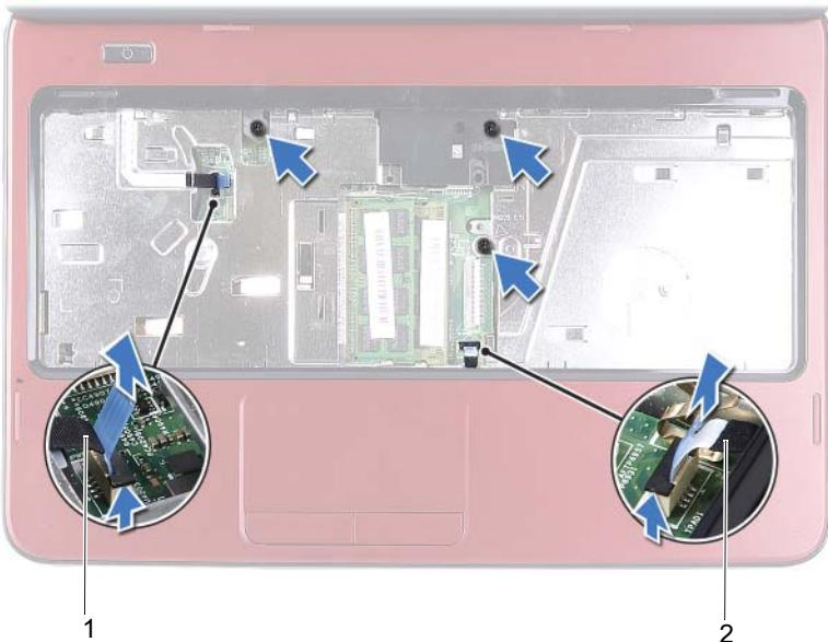
1 kabela ploče s gumbom za uključivanje/isključivanje
